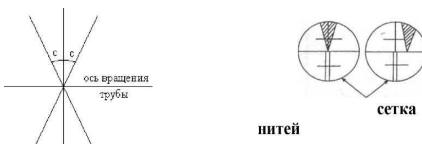
Рис. 3 Определение коллимационной погрешности:
