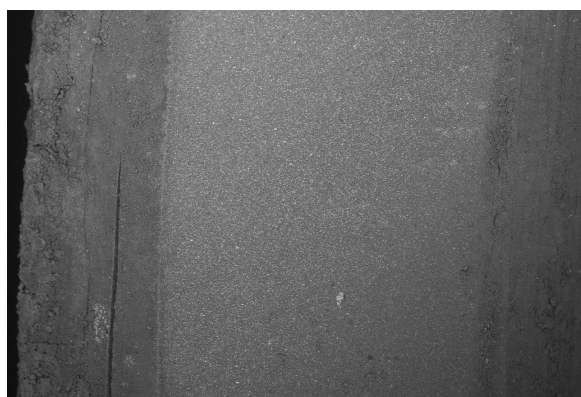
Рис. 2. Фотография рабочей поверхности маслосъемного кольца (увеличение в 60 раз)
