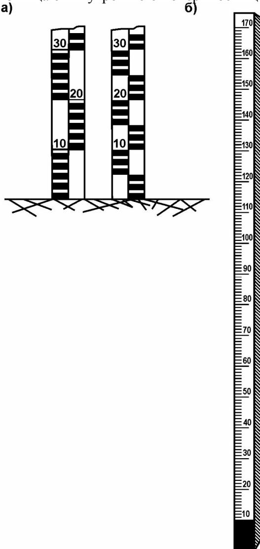
Рисунок 11 - Рейки снегомерные: а - стационарная, б - переносная.
