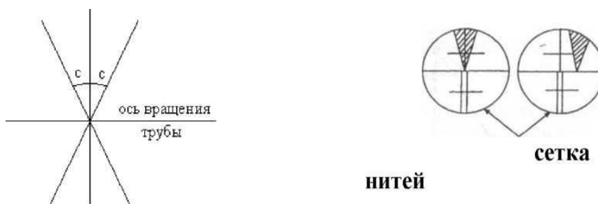
Рис. 3 Определение коллимационной погрешности:
