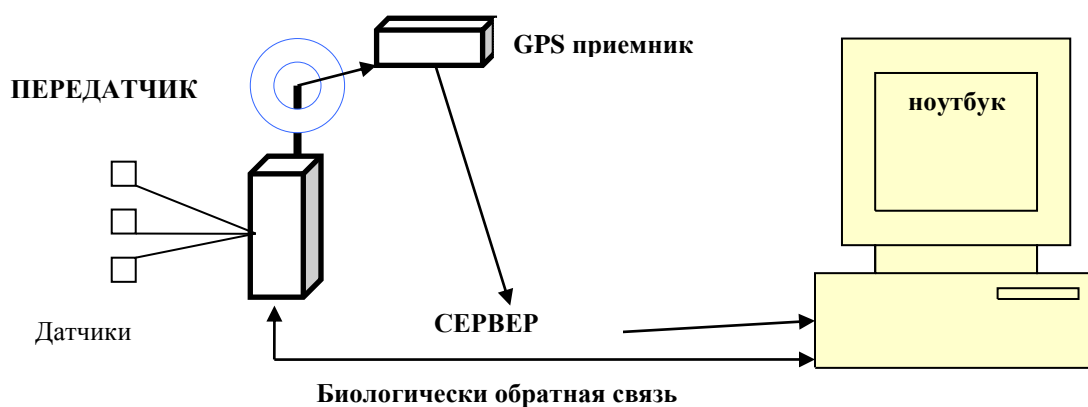
Рисунок 5 - Общая схема телеметрической системы
