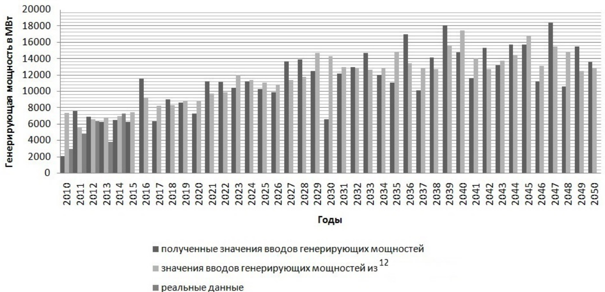
Рисунок 2 — Сравнение стратегий ввода генерирующих мощностей с 2010 по 2050 г. для достижения роста располагаемой мощности на 2 % ежегодно
