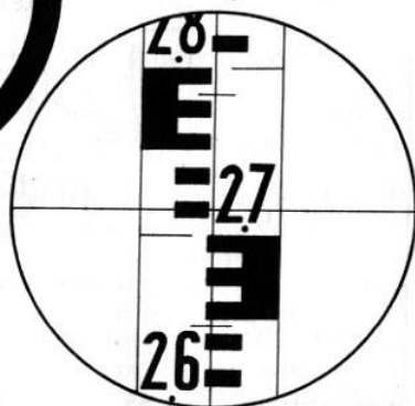
Поле зрения зрительной трубы нивелира Н-10КЛ
