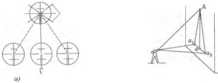
Рис. 4. Схема проверки горизонтальной оси вращения трубы: а — неправильное положение оси вращения трубы; б — установка теодолита при выборе точки А и ее проецирование
