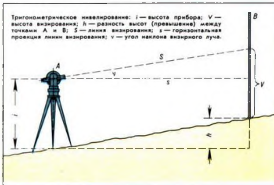
Рис. 16. Схема тригонометрического нивелирования
