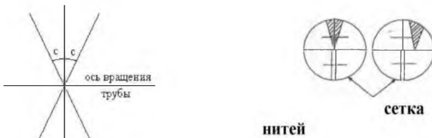
Рис. 3 Определение коллимационной погрешности: а — расчет коллимационной погрешности; б — исправление коллимационной ошибки с перемещением вертикальной нити
