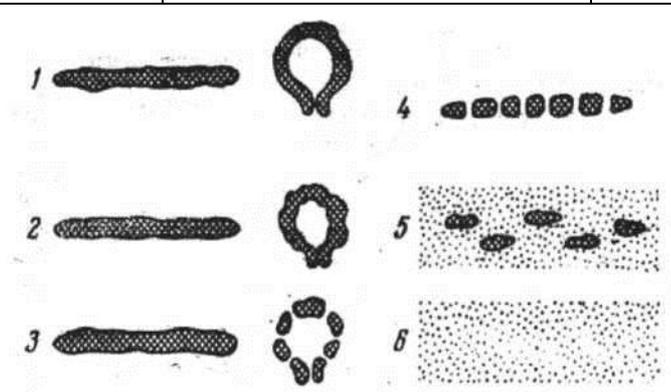
Рис. 3. Определение гранулометрического состава почвы влажным методом
