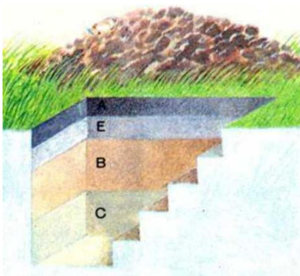
Рис. 4. Почвенный разрез
